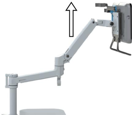
2. Dengan menggunakan kunci pas heksagonal berukuran 4 mm, putar sekrup penyesuaian pegas searah jarum jam untuk meningkatkan kekuatan pengangkatan lengan, atau melawan arah jarum jam untuk menurunkannya. *Penyesuaian yang optimal akan memungkinkan lengan untuk tetap di posisinya tanpa turun atau naik dengan sendirinya.*
