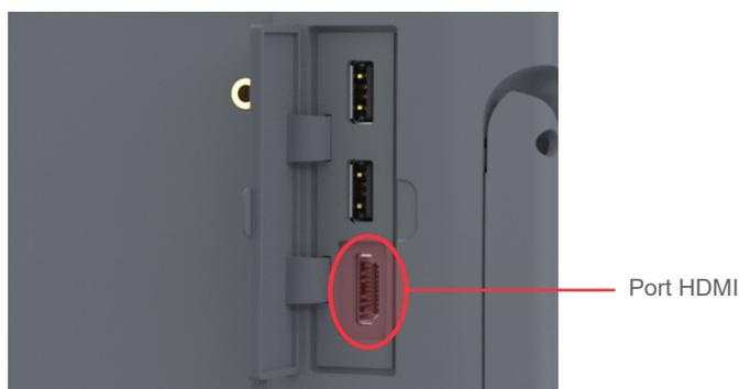
3. Raccordez l'autre extrémité du câble au port HDMI d'un moniteur externe agréé pour un usage médical.
