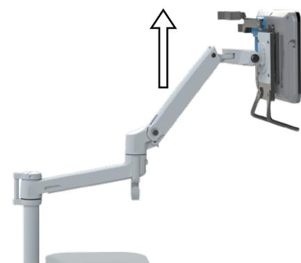
2. À l'aide d'une clé Allen de 4 mm, tournez la vis de réglage du ressort dans le sens des aiguilles d'une montre pour augmenter la résistance du ressort de levage du bras, ou dans le sens inverse pour la diminuer. *Lorsque le bras reste en position, sans s'abaisser ni s'élever seul, le réglage est optimal.*
