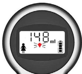
点滅しない矢印アイコンが表示されている場合、膀胱の大部分はスキャン範囲内に確認できています。適切な測定ができましたが、正確度を確認するため、矢印の方向にプローブを移動して、再度スキャンすることを推奨します。
