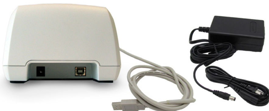
Figure 4. Chargeur de batterie/concentrateur sans fil
